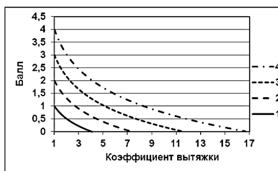
Рис. 2. Влияние степени вытяжки на проработку макроструктуры непрерывнолитой заготовки:
